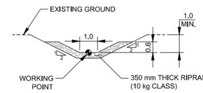
SCALE 1:100 m **C** OUTLET CHANNEL TYPICAL SECTION
