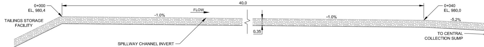
SCALE 1:50 m **1** SPILLWAY DETAIL
