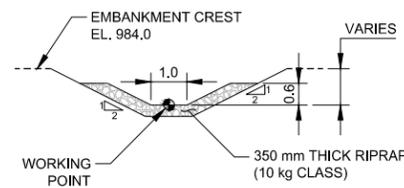
SCALE 1:100 m **B** SPILLWAY CHANNEL TYPICAL SECTION
